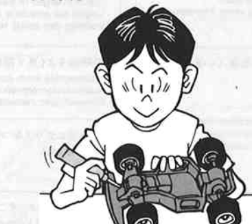
⑧ ギヤや軸受け部、サスペンションなどの可動部はグリスを注しておきましょう。
